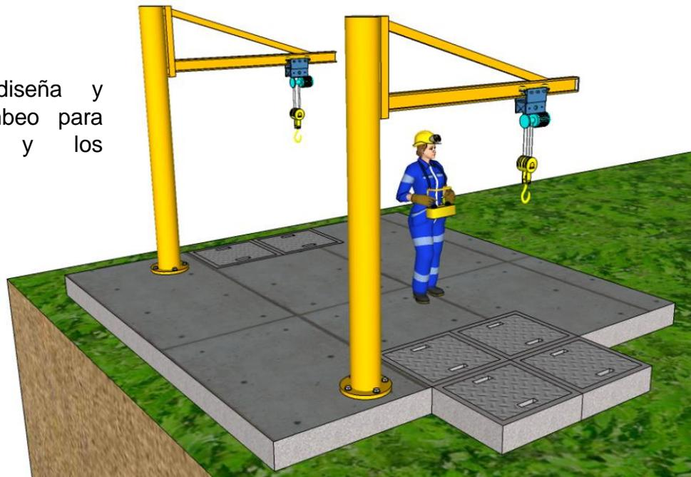
**Bio Pro S** ®: cárcamo de bombeo con cribado grueso, bombeo dúplex y sistema de izaje motorizado
