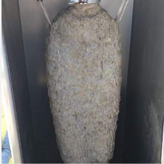
Foto 21: Saco de cribado roto, no se realizó el cambio por 5 días por falta de stock.
