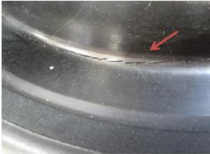
FOTO 13 - FISURA DEL FILTRO Terciario # 4
