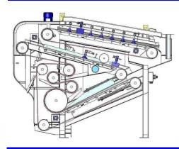
El sistema combinado CC está diseñado para una deshidratación mecánica contínua para lodos de tipo industrial o urbano.
