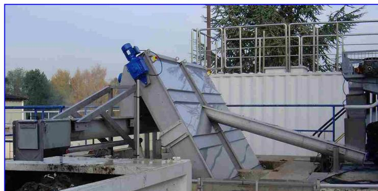
La cadena de tipo resistente ha sido seleccionada para su alta duración de vida, sin necesidad de mantenimiento y evitando que se bloqué ya que nunca está tensionada.
